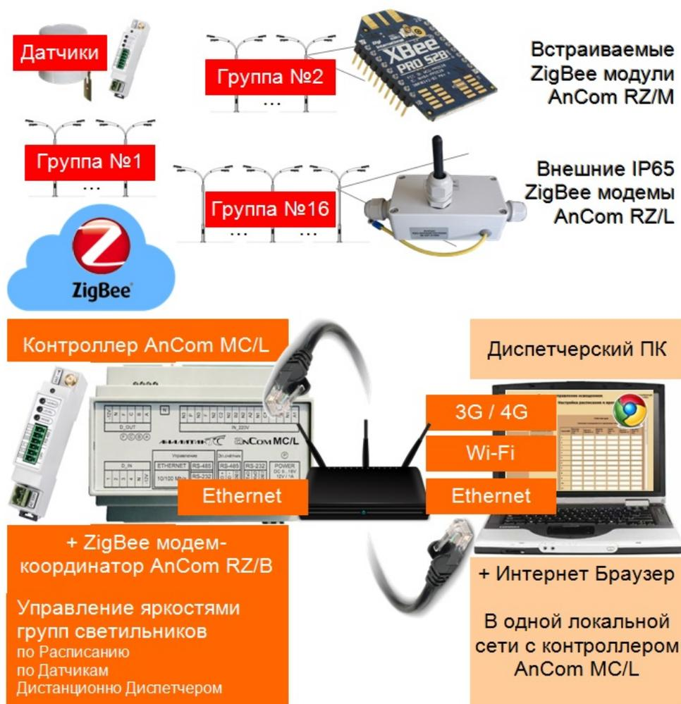
Адресные команды на управление яркостью Групп светильников, а также на включение/выключение линий светильников А, В, С - формируются и передаются по беспроводной сети контроллером АСУНО AnCom MC/L
